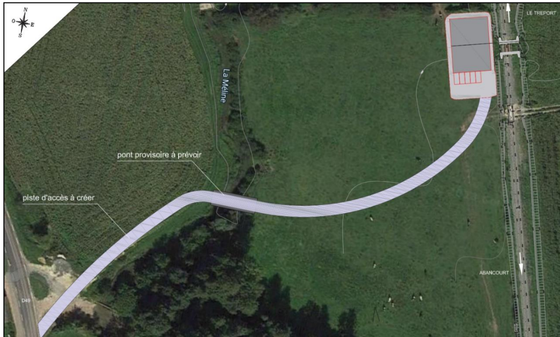
Figure 7 : Ligne 325 000 – Accès au chantier et création du pont provisoire
